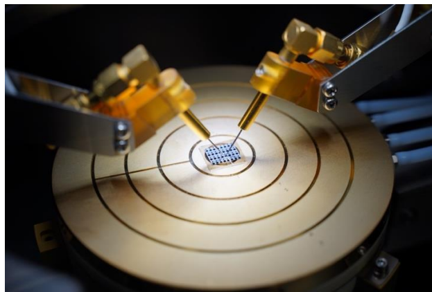
AlN系SBDの電気的特性の測定の様子
