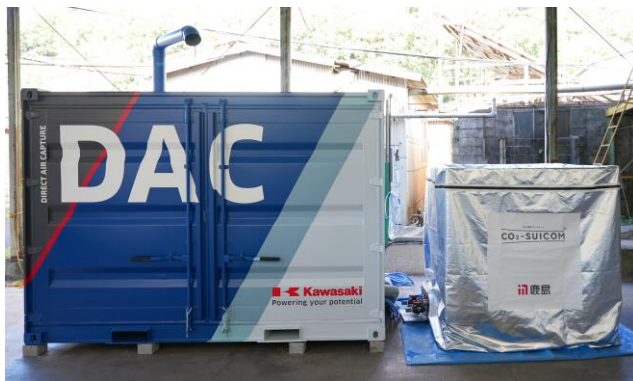
DAC 装置（左）と炭酸化養生槽（右）
