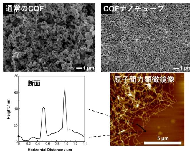
図1. 1次元COFナノチューブの微細構造。
