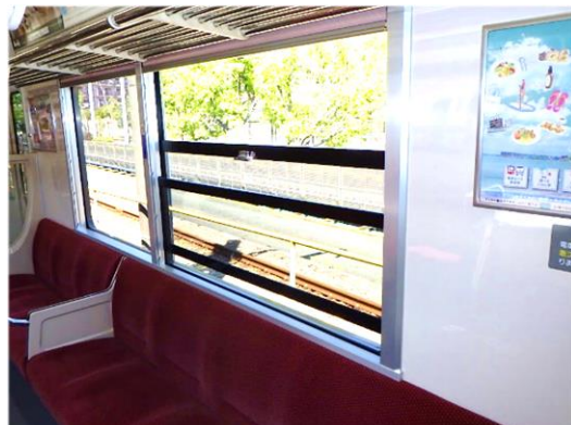
<窓の開閉化例（二段下降窓）>
