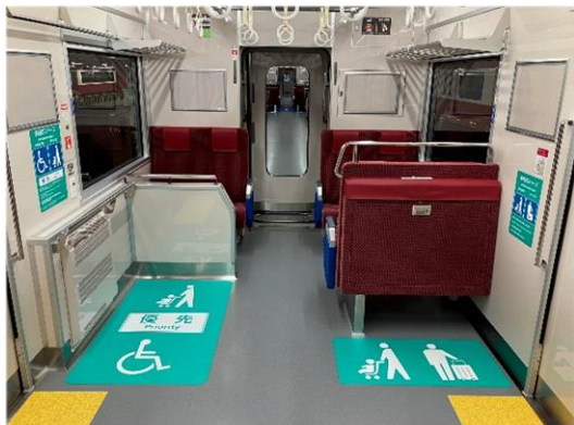
<多目的スペース設置例>
