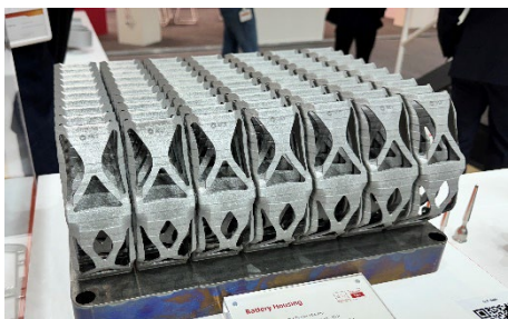
量産部品事例 EV 自動車用バッテリー保護ケース
