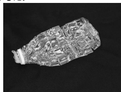
▲ブレ裁断圧縮方式により減容したペットボトル
