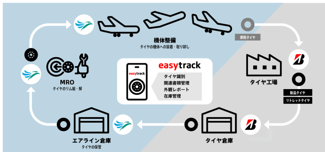
タイヤ個体管理システム「easytrack」の概要イメージ
