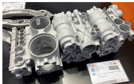
組み立て工程を必要としない一体造形例 自動車のエンジンパーツ
