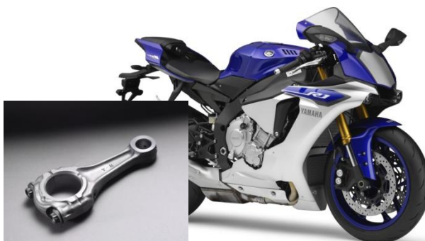
「Super-TIX®」を使用したバイクの接続ロッド ヤマハ発動機株式会社 提供
