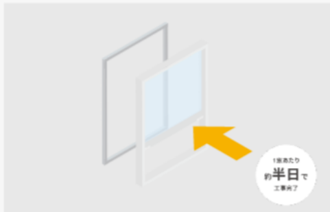
今ある枠を残して新しい窓に交換
