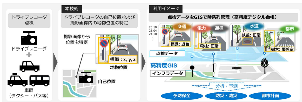
図 1. 本技術によるドライブレコーダ点検画像のインフラ設備位置特定および GIS 管理
