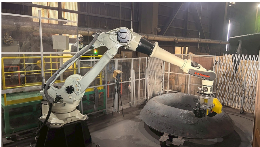
作業者の遠隔操作により大型鋳物製品を研削加工するロボット
