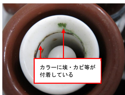
（図 3）固定モールドの汚損例
