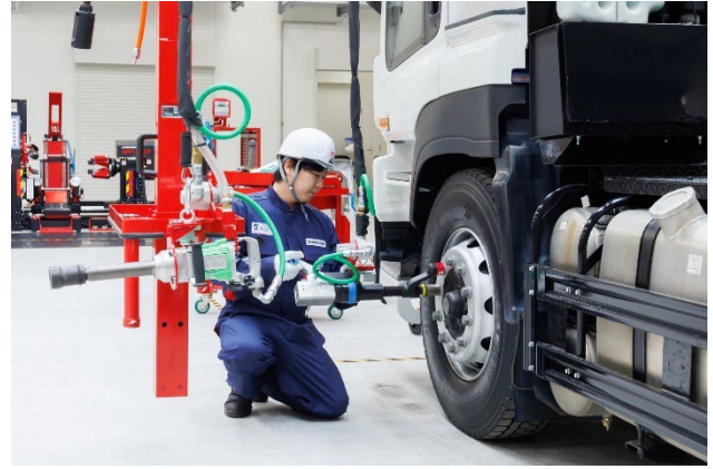
軽労化機材のバリアツールハンガーを用いて作業する様子
