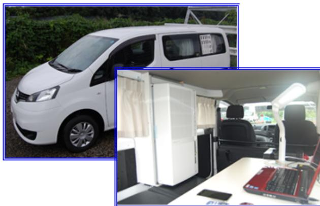
車両は、日産「NV200」を改造し、カーナビやETC車載器のほか、事務所機能として折り畳み式のテーブルと椅子、車両用DC12VからAC100Vへ変換するインバーター、外部電源取り出し機能、LEDルームランプ、後部座席ウィンドウフィルムとカーテン、エンジンOFF時に使用可能な簡易型エアコンを装備しています。お客さまを迎え入れる移動店舗車両とは異なり、事務作業を行うのに最低限かつ必須な機能に絞り込むことで、導入コストを抑えています。今後は、お客さまの用途に基づいた仕様にて、オーダー製作にて展開するとともに、代表的な仕様の車両を順次各エリアの「オリックストラックレンタル」営業所に配備していく予定です。
