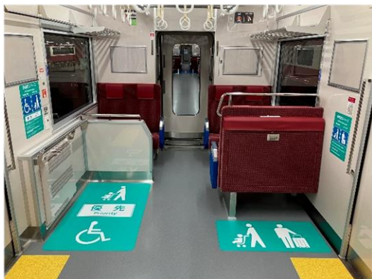
<多目的スペース設置例>
