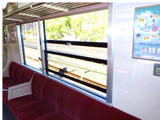
<窓の開閉化例（二段下降窓）>
