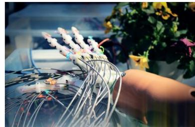
進化系ロボットアーム「筋電義手」
