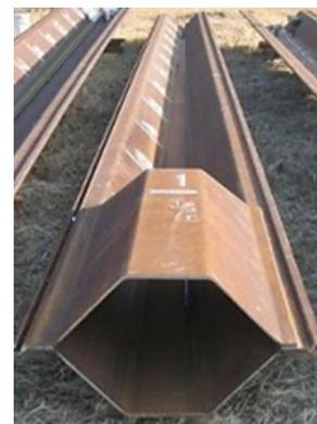
図2 先端加工鋼矢板
