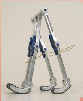
私たちは何気なく足を出して 2 足歩行をしています。ロボットの歩き方はカクカクしているイメージがしますよね。スムーズな足の動きはロボットで動かすととても大変で「歩くこと」が複雑な仕組みであることを教えてくれます。受動歩行ロボットは、アクチュエータ、センサおよび制御を一切用いずに、重力のみによって緩やかな下りスロープを歩くことができます。受動歩行はエネルギー効率が高く、ヒトの歩行に近いです。本コースでは、受動歩行ロボットの研究を紹介するとともに、実際にロボットを体験します。
