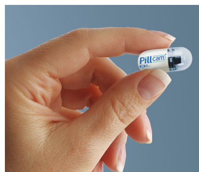
PillCam® SB 2 plus カプセル 11×26mm と大きめのビタミン剤程度。 これまで 80 か国以上で 170 万人以上の 使用実績があります
