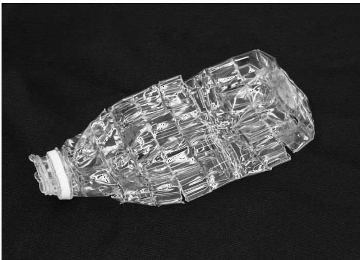
▲プレ裁断圧縮方式により減容したペットボトル
