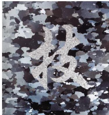
(写真③) 方向性電磁鋼板の結晶粒を制御する技術の例)
