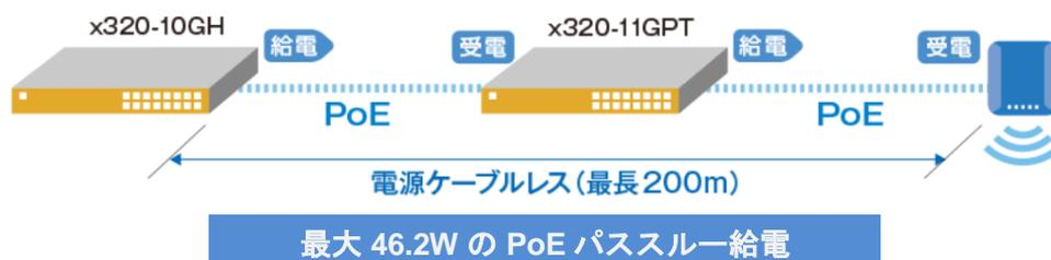
「AT-x320-11GPT」「AT-GS980EM/11PT」はファンレスデザインとアライドテレスリスの独自 OS である AlliedWare Plus OS による豊富なスイッチング・ルーティング機能を備えた、レイヤー3 ギガビット・インテリジェント・スイッチです。最大 30W の PoE+給電が可能で 1GbE ポートを 8 ポート搭載し、さらに PoE の受電が可能な PD ポートを 1 ポート搭載したモデルです。AC アダプター駆動の場合は筐体あたり最大 62W、PoE++スイッチからの 90W PoE++受電の場合は、最大 46.2W の PoE 給電が可能で PoE パススルー機能に対応するため PoE 給電の自由度を向上させます。
