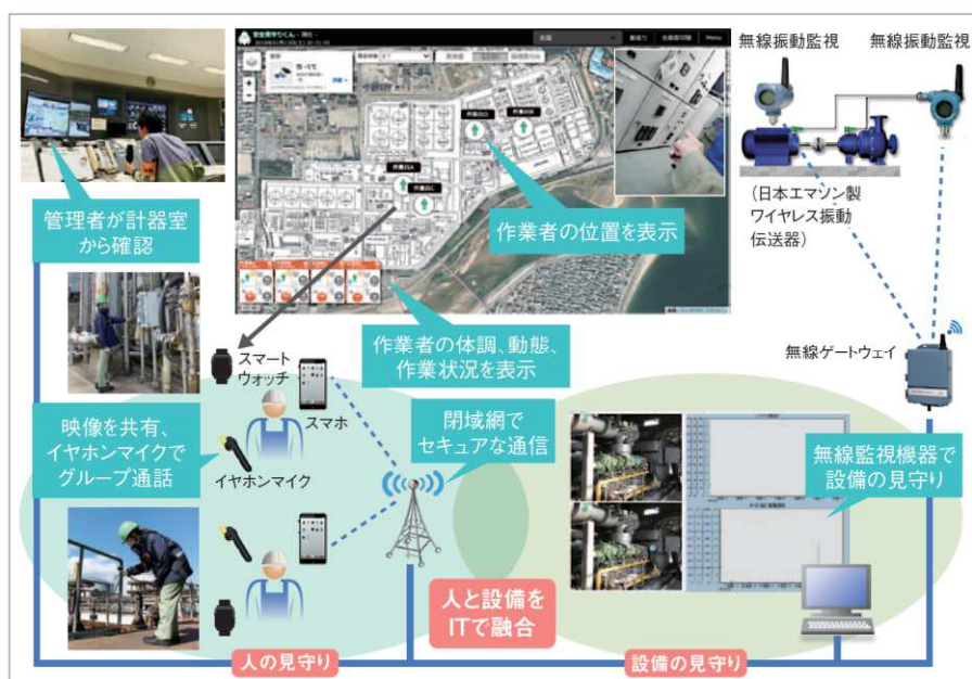
図)昭和四日市石油が導入したフィールド作業支援システムと振動監視システム
