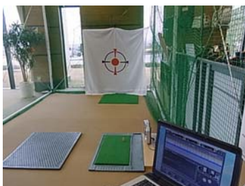
室内に設置された弾道測定器
