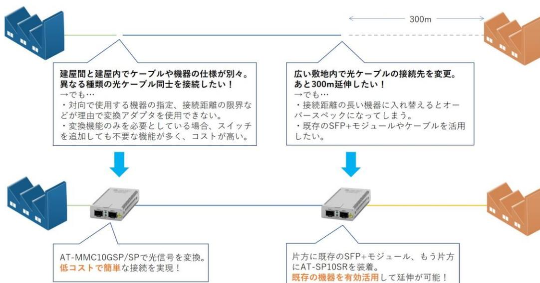
AT-MMC10GSP/SP は、10G に対応したリピータータイプのメディアコンバーターです。SFP+スロットを2ポート搭載しており、お客様のネットワーク環境に最適な SFP+モジュール<sup>(\*)</sup>を選択してご利用いただくことで、300m～80km<sup>(\*\*)</sup><sup>(\*\*\*)</sup>までの距離を10Gbpsで接続することが可能です。両方がSFP+スロットとなっていることにより、仕様の異なる光ケーブル同士の中継や延伸に利用でき、既存の機器を有効活用しながら光ファイバーネットワークの拡張性を高めることができます。
