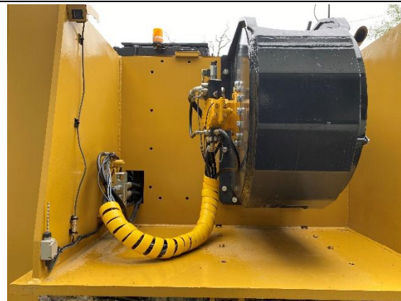
テザー背面に搭載されたウインチとワイヤー。250m のワイヤーが格納。 左側には拡張ウインチ搭載スペースあり。 将来自前でワイヤーを搭載するなどの拡張余地をもつ。
