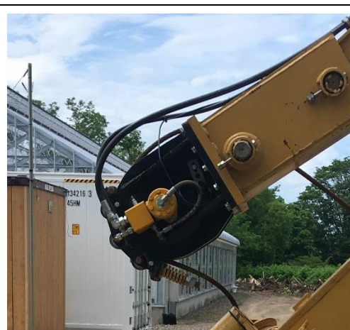
折り畳みタワーの先端につけたワイヤー張力調整装置(イジェクター)
