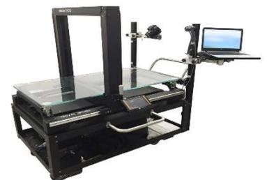
新たに「サイズマスター」機能を追加。SPK シリーズと接続し、採寸計量データの編集や、基幹システムへの連携によって正確なサイズマスター作りを強力にサポート。
