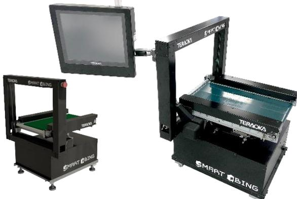
ポスト投函サイズの小型荷物に特化し、10g/2.5mm 単位の高精度採寸計量を実現。コンベヤー上に荷物を流すだけで、バーコードスキャン/サイズ計測/計量を瞬時に行う。本体は設置場所を選ばない長さ 68×幅 73cm のコンパクトモデルで省スペース。100v 家庭用電源で使用でき、スペースに制限のある倉庫や荷量に応じて移設を考えている荷主様に最適。
