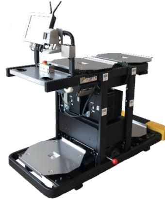
業界初の秤付き自律走行カート。独自のアルゴリズムで最適ルートを自動走行し、作業者の負担を大幅軽減。指示を受信すると自動で商品棚まで移動するため、少ない人数でも高効率のピッキング作業ができ、省人化・効率化を実現。
