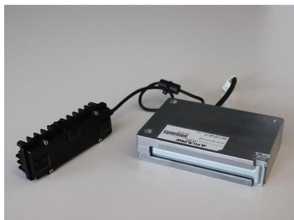
また、業界に先駆けて独自開発した歩道走行用の障害物検知アルゴリズムにより、壁やフェンス、路上のブロックや段差、路面の穴や溝、法面のほか、電動カートによる事故多発の原因となる踏切の遮断桿も検出対象として捉えることが可能です。天候の変化や日向・日陰の混在といったカメラ画像に影響を及ぼす光量の変化が大きい環境でも物体との距離やその形状を把握することができます。さらに白線や点字ブロックなど障害物として誤検出されやすい路面サインについては、AIを活用した画像認識により誤検出を軽減します。電動カートのみならず、時速6kmまでの移動体であれば、本ユニットを搭載することで障害物検知によるさまざまなソリューションを実現することができます。
