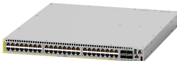
サーバー・ストレージなどの10Gデバイスや、10G対応スイッチの集約スイッチ用途はもちろん、100Mから10Gまでの5つのスピードに対応するため、マルチギガ対応スイッチとの既存配線を利用した帯域拡大や、低速のレガシー端末はそのままに既存スイッチのリプレースを可能とする製品です。
