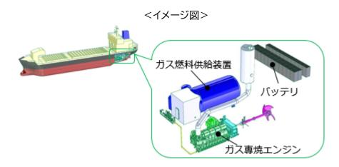
本船は2024年2月運航開始予定で、国内初の天然ガス専焼主機と 2,847kWhのリチウムイオンバッテリを搭載し、LNG タンクには日本製鉄(株)が開発した7%ニッケル鋼板を舶用タンクとして初めて使用することを計画しています。巡航時には川崎重工業(株)が開発した天然ガス専焼エンジンにて推進力と船内電力を供給します。天然ガスのみで高出力、長距離、長時間の航行を行います。入出港時や停泊時はバッテリから推進力と船内電力を供給し、ゼロエミッション運転を実現します。
