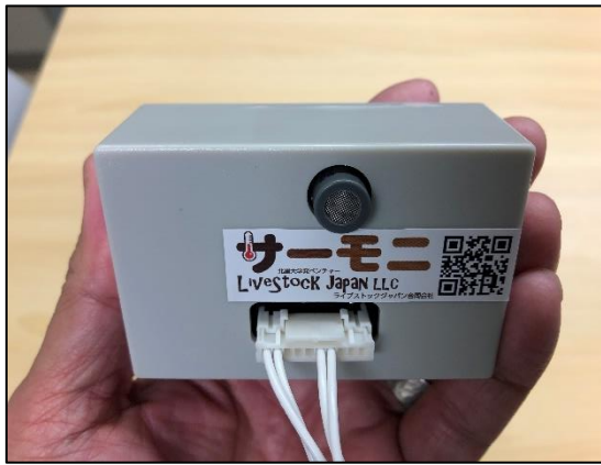
【図1】『簡易メタンガスモニタリングシステム“サーモニメタン”』専用センサー（左）と酪農牛舎での測定（右）
