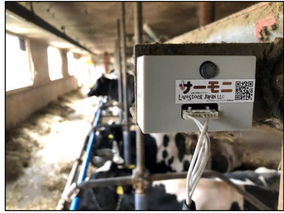
【図1】『簡易メタンガスモニタリングシステム“サーモニメタン”』専用センサー（左）と酪農牛舎での測定（右）
