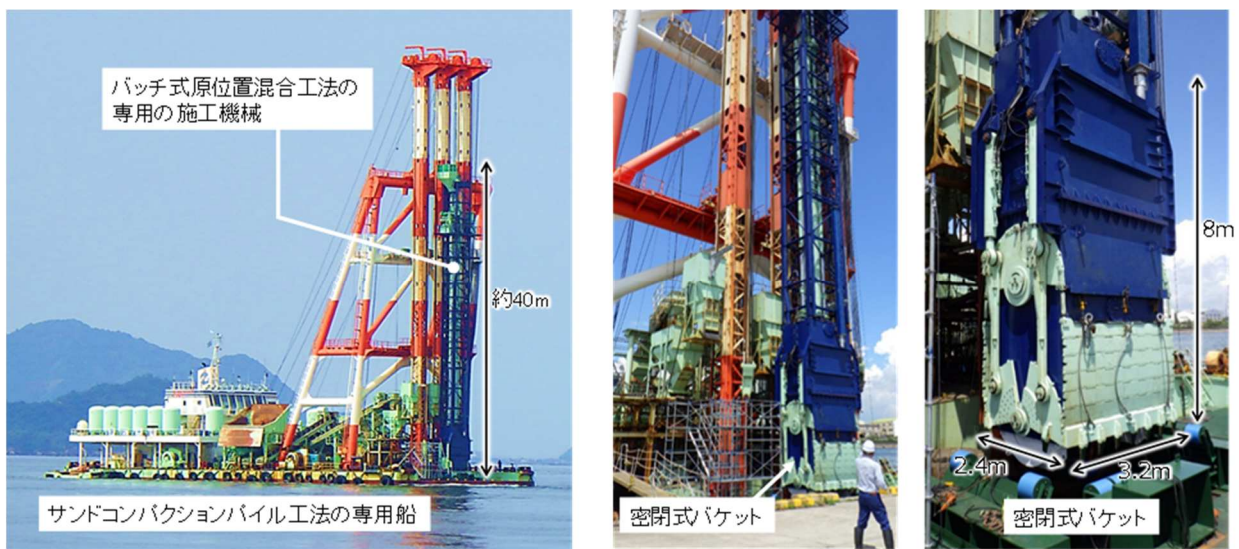
【図2】バッチ式原位置混合工法の施工船
