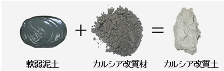
【図1】カルシア改質土の外観
