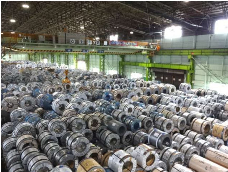
図) 豊田スチールセンターの鋼板倉庫。10 万トン以上の鋼板を保存することが可能で、15 機のクレーンで鋼板の運搬が行われている。
