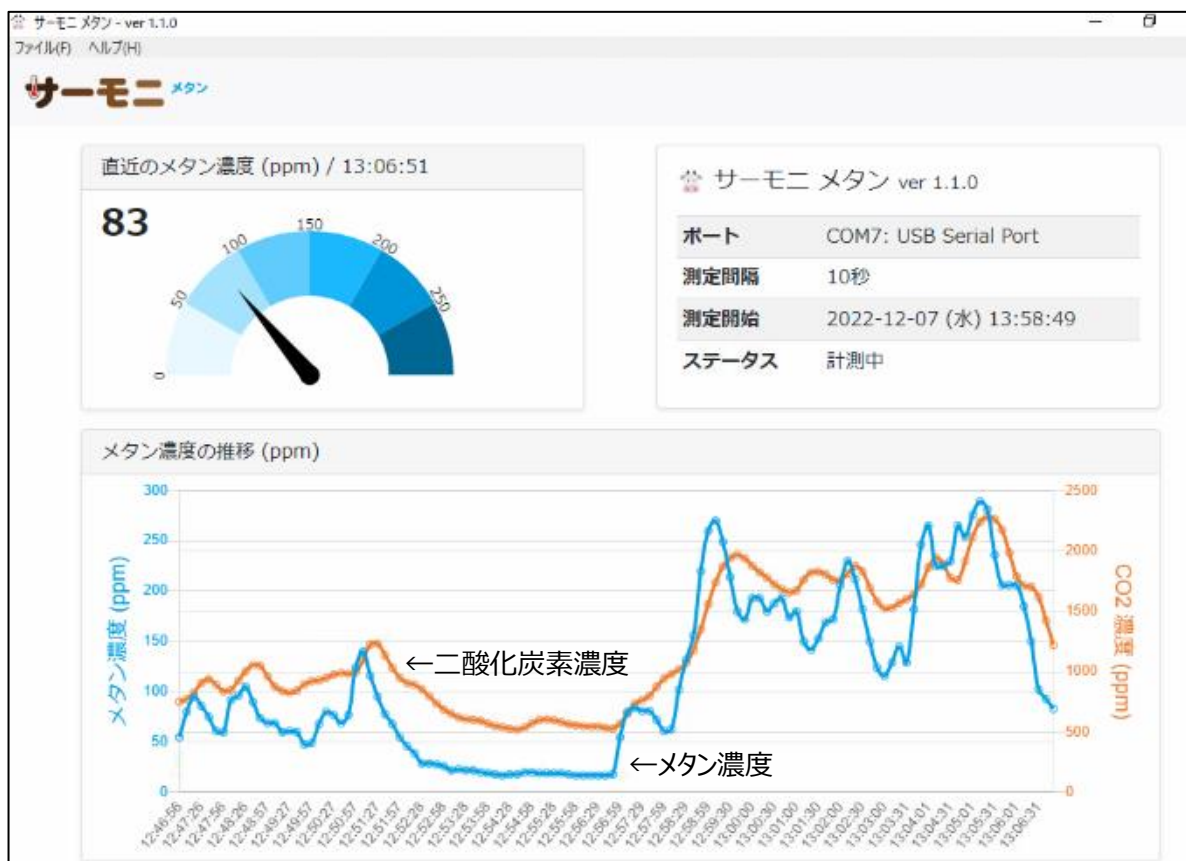
【図2】『簡易メタンガスモニタリングシステム“サーモニ メタン CO 2 プラス”』専用アプリ画面 (測定濃度の表示例)
