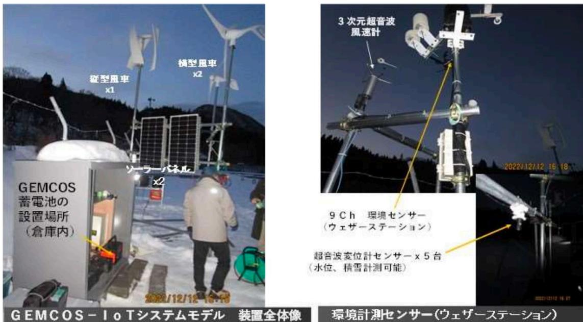
図 4. 鱸ヶ沢町立アユ養殖場で実施した、GEMCOS-IoT システム装置、遠隔的な環境計測 (ウェザーステーション) と機器制御用 GEMCOS 蓄電池、人工養殖モデル実証試験の風景。
