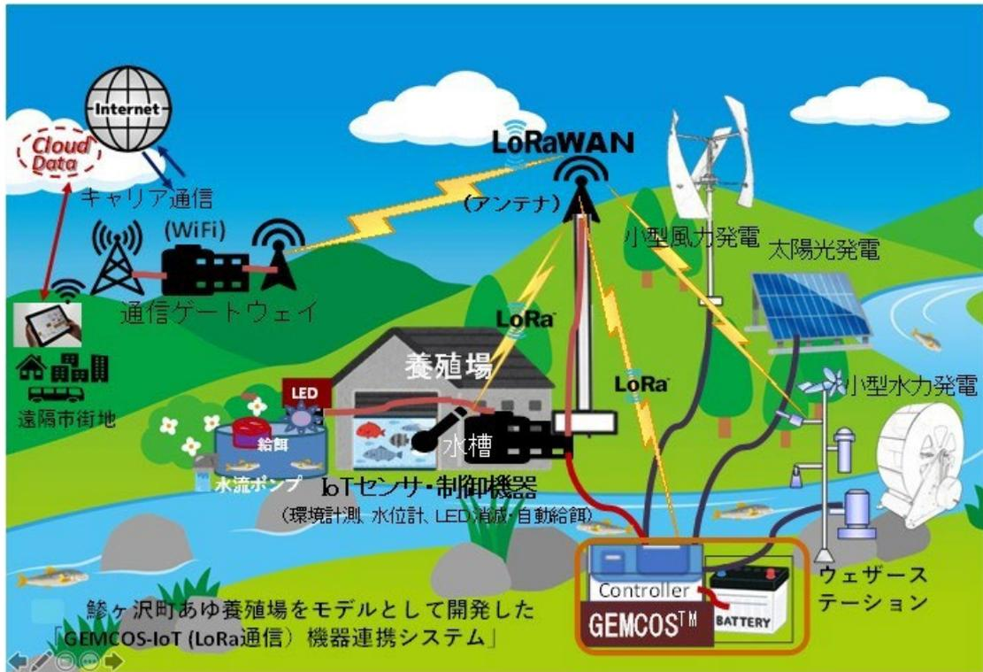
図 3. 青森県鱸ヶ沢町の白神山麓・赤石川流域にあるアユ養殖場で実施した、GEMCOS-IoT システムを活用した設備、LoRa ネットワークシステムの構成および実証試験の概要。
