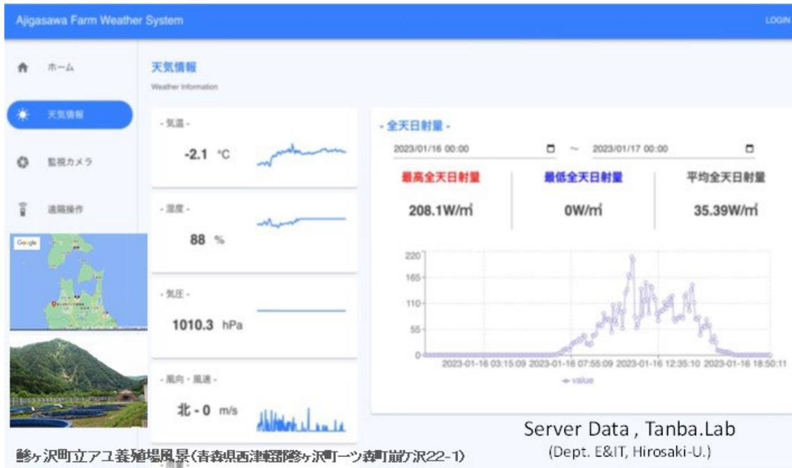
図 5. 青森県西津軽郡鱈ヶ沢町立アユ養殖場で、GE-MCOS-IoT システムと LoRaWAN ネットワークを使って、環境データ(天候、気象、積雪深さ)を常に観察できるクラウド上のデータ事例。
