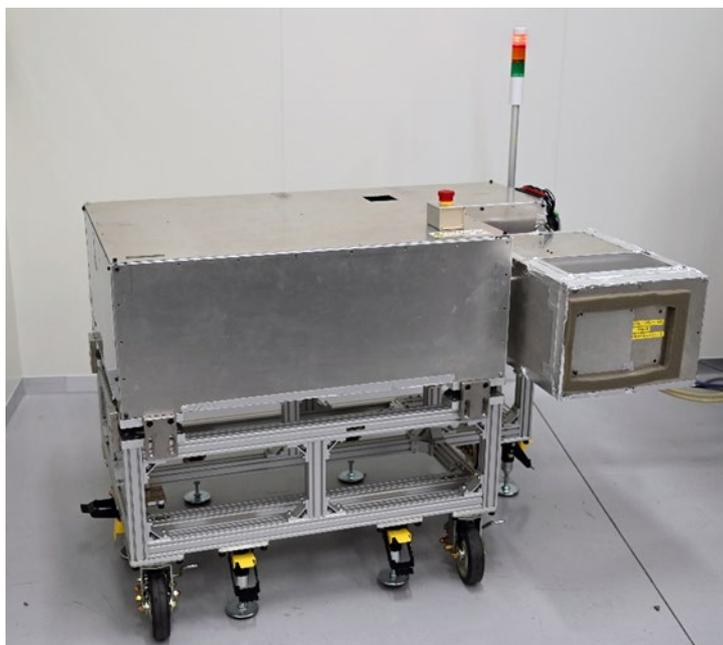
ニコンが開発したリブレット加工を行うための可搬型の光加工機
