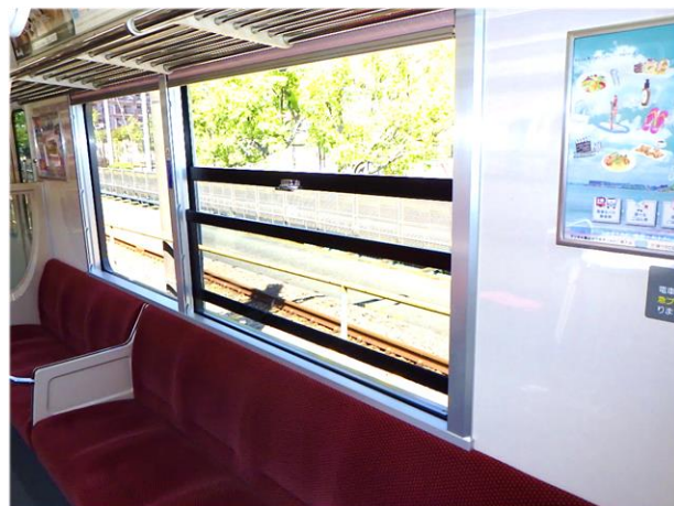
<窓の開閉化例（二段下降窓）>
