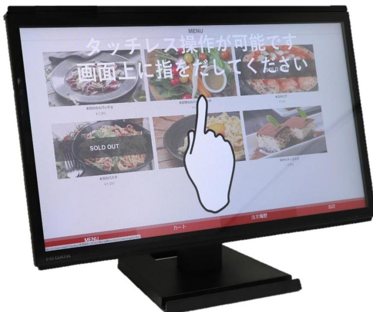
図 1. AirInput™ パネル 15.6 inch Wide XYタイプデモ機
