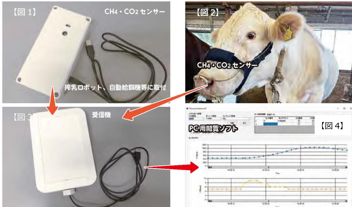
【図 1】 無線型メタンモニタリングセンサー（小型ボックスにメタン、二酸化炭素センサーを収納） 【図 2】 ウェアラブル型メタンモニタリングセンサー（メタン、二酸化炭素センサーを一体化した頭絡） 【図 3】 センサーデータを無線で受信するための受信機 【図 4】 センサーデータのリアルタイム閲覧用ソフト画面
