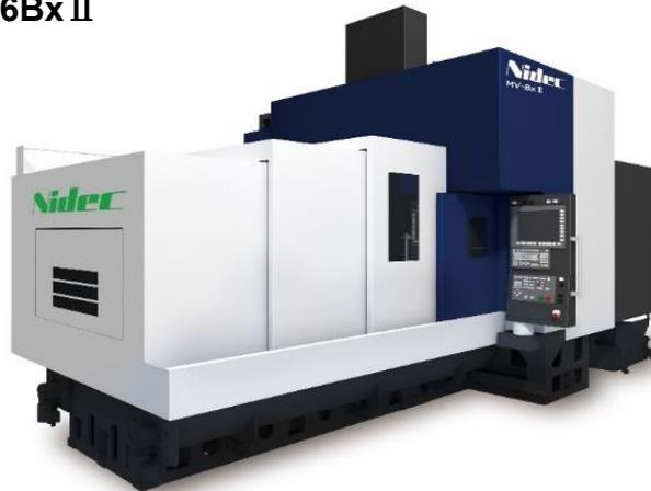
MV16BxII (1.7×2.2m) は、門型マシニングセンタの 50 番主軸を搭載するコンパクトタイプとしては、主軸最高回転速度  $7,000\text{min}^{-1}$ 、X・Y・Z 軸の早送り速度を各 32m/min の最速化を図り、非切削時間を短縮しました。また、重量ワーク（被加工物）に対応するため、最大積載質量を 8 t に設定。X 軸にリニアガイドを 3 列配置した、たわみを抑える高剛性構造とし、高速加工でも安定した加工を実現します。もう一方の MV12BxII (1.3×3.0m) は、基本性能はそのままとし、長尺ワークに対応するため、テーブル長さを 3,000 mm とし、最大積載質量を 5 t に増やしました。いずれも先に発売した MV12BxII (1.3×1.6m) よりも大きなワークへの対応と生産性向上を図っています。
