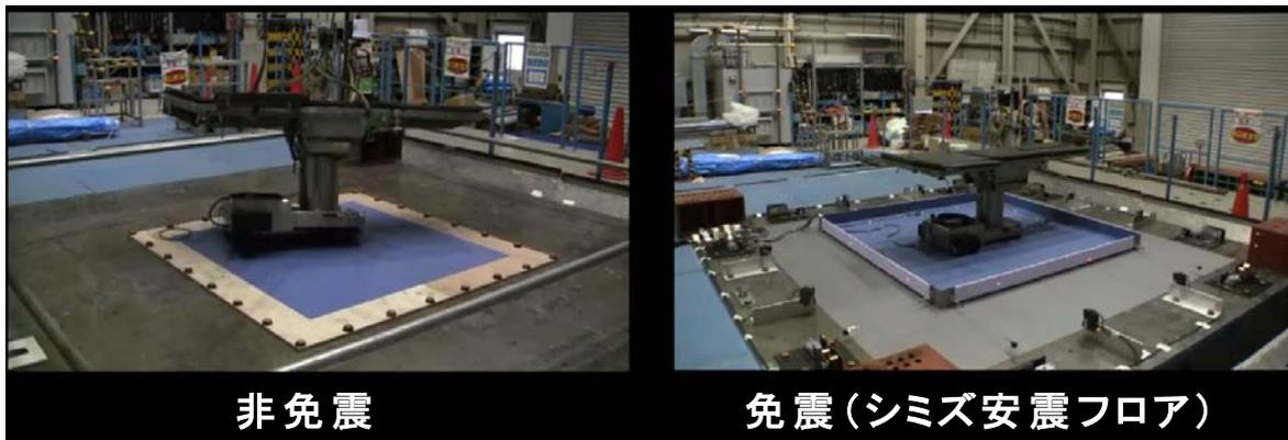
大型振動台により、震度6強の揺れを再現した性能検証実験の様子。シミズ安震フロアにより免震化した手術室では免震プレートがゆっくり移動するだけで手術台の移動・転倒は確認されなかったが、非免震の手術室では手術台が激しく動き、転倒寸前の状態になった。
