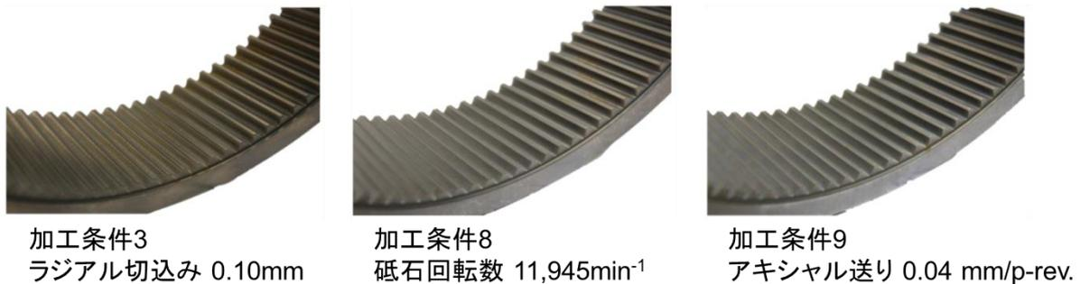
図11 ナイタルエッチング検査結果
