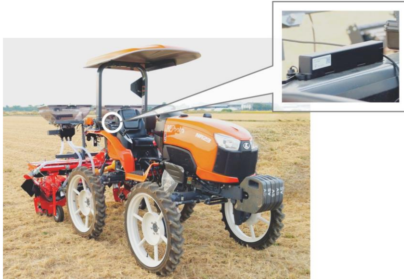
農機に Sigfox デバイスを後付け装着したイメージ
