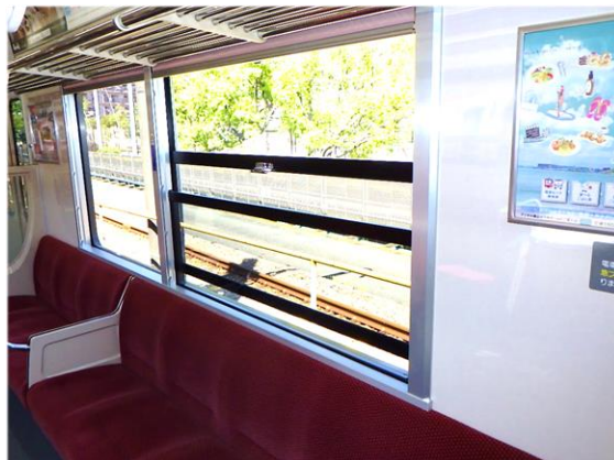
<窓の開閉化例（二段下降窓）>
