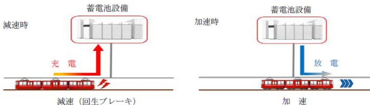
<回生電力貯蔵装置のイメージ>
