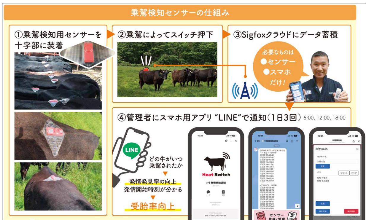
【図 3】開発した発情検知システムの仕組み
