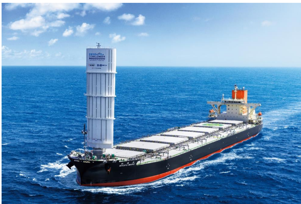
帆を稼働して航海中のウインドチャレンジャー搭載石炭船「松風丸」
