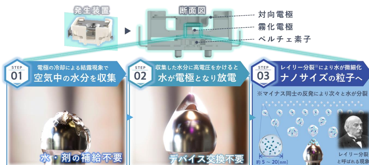
図7. ナノイー（帯電微粒子水）発生装置
